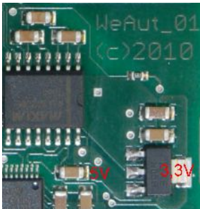
Bild 28: Messpunkte für Vcc (5V +/- 0,1V) 2 Durchkontaktierungen und für 3V3 (3,3V +/- 0,1V) "Pad" des Reglers
