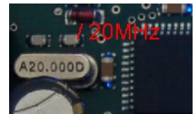
Bild 30: Messpunkt: rechts am "rechten Kondensator" C17
